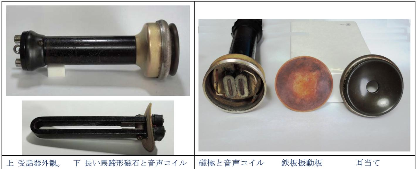
振動板は、鉄板に金属がメッキされた直径53mm、厚さ0.19mmであり、僅かな余裕で磁極に引き寄せられている。振動板は黄銅の構造物に実に丁寧に締め付けられている。音声電流が大きい瞬間振動板が引き寄せられ、減ると戻って振動し音声を発生する。重さは350gもありかなり重い。巻線には絹巻線が用いられていたが長年の間に腐食し断線している。
